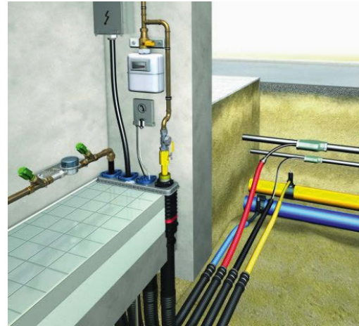
Abbildung 5: Mehrspartenhauseinführung Bsp.: Strom, Trinkwasser, Gas, Breitband Nicht unterkellertes Gebäude (Quelle: DOYMA GmbH & Co)
